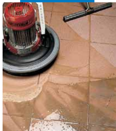
Porcelánburkolatú padló tisztítása korongos csempetisztító-géppel vagy gumilehúzóval
